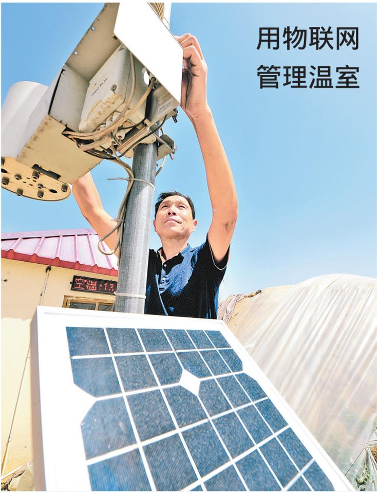
近日，新乐市河北庄稼主生态农业科技示范园的管理人员正在维护物联网监控设备。据了解，该示范园已经有60个大棚通过无线传感网络、移动通信网络、互联网和云计算技术，实现了对温室大棚的远程控制。记者 杜柏桦 通讯员 贾敬杰摄
