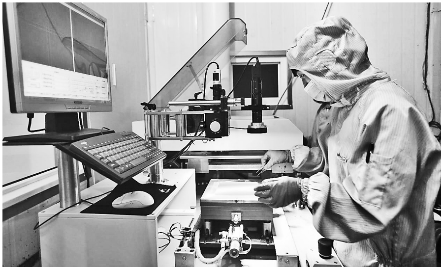
近日,衡水高新区的汉盛光电科技有限公司车间内,工人正在进行印刷银电极试验,以提高太阳能电池发电效率。 记者 马路 通讯员 陈康摄
