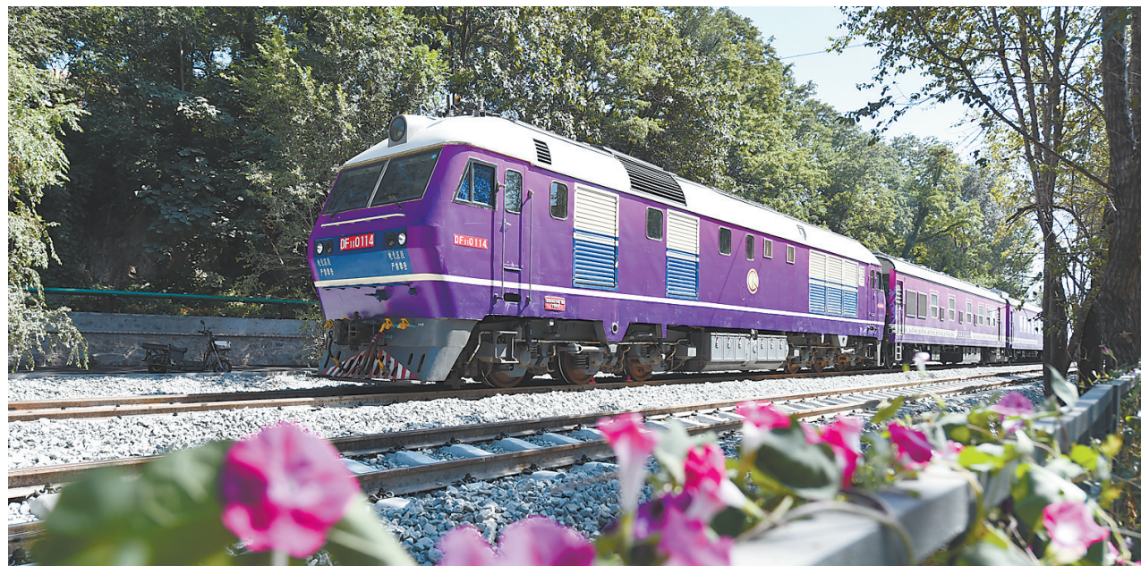
9月17日，秦皇岛秦旅山海号旅游观光列车在秦皇岛旅游铁路上进行项目观摩运行测试。列车最高时速为60公里，共五节客车厢，可同时容纳436名乘客。 记者 赵永辉摄
