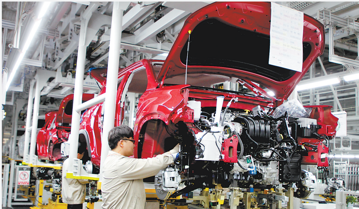
11月15日,在北京现代沧州工厂总装车间,工人正在安装发动机前悬。
