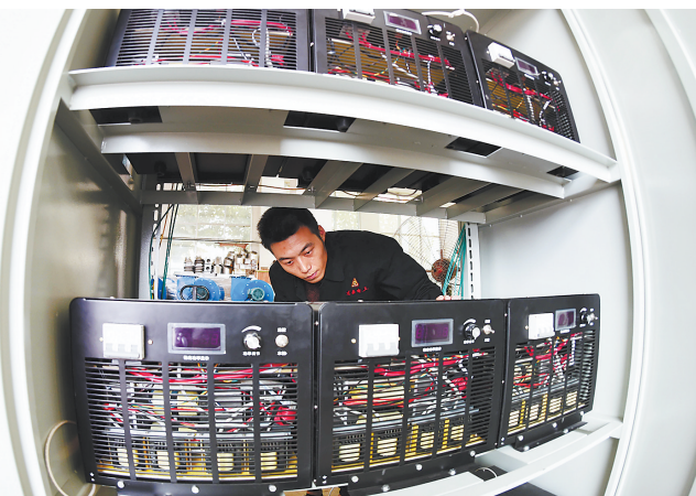
日前,位于宁晋县方大科技园的邢台龙嘉电子设备科技有限公司研发人员,在调试待出厂的紫外光辐照交联设备。
