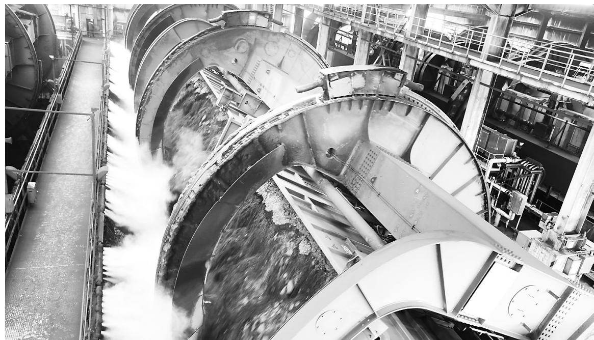
日前,载煤列车在国投曹妃甸煤码头翻车机房进行冻煤翻卸作业。王育民摄
