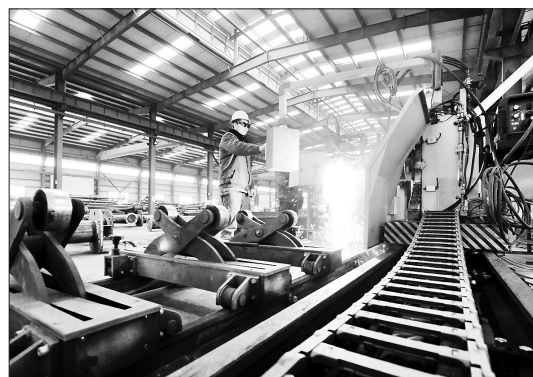
近年来,乐亭县不断加大力度,引进京津优质产业资源,推进县域经济转型升级。这是近日北京实宝来有限公司与乐亭本地一家企业合作建设的游乐设备制造基地车间内,工人在加工过山车立柱组件。 刘江涛摄
