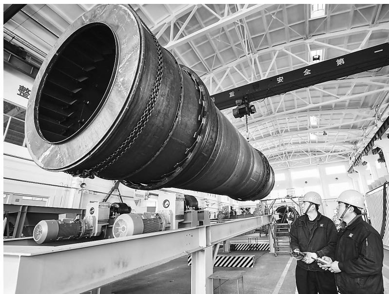
1月19日,永清县德基机械公司的工人在吊装调试沥青混合料搅拌设备的烘干滚筒。多年来,公司坚持科技创新之路,目前,公司拥有58项国家专利及28项中国软件著作权,产品出口俄罗斯、澳大利亚等国家。
