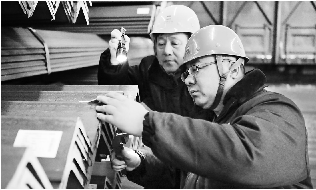
2月19日,河钢宣钢型材事业部党员正在细致检查外角钢外形尺寸。今年以来,河钢宣钢型材事业部党委开展了树立党员风貌、争当提质标杆主题实践活动,集中实施角钢负差率攻关,满足客户个性化需求,角钢质量合格率达到100%。 记者 王雪威 通讯员 李巍摄
