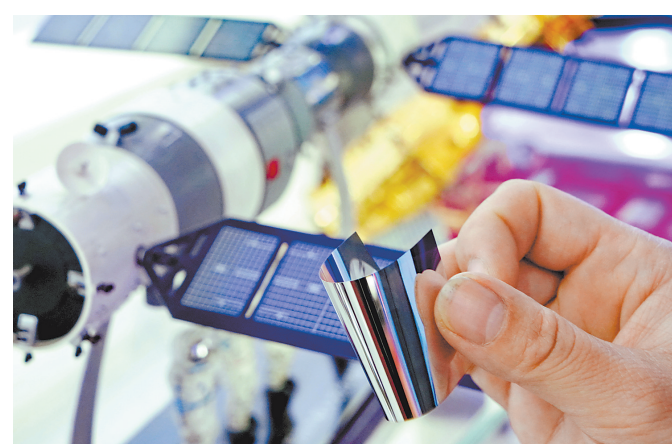
近日,秦皇岛经济技术开发区星箭特种玻璃有限公司的工人在展示高强度柔性抗辐射玻璃盖片。
