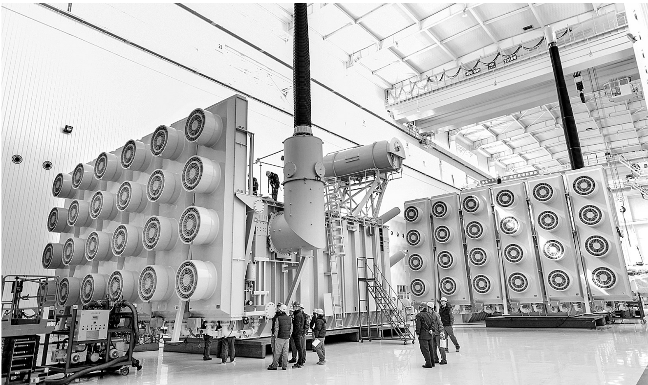
近日,由天威保变(秦皇岛)变压器有限公司生产的首台侧电压为550kV、网侧电压1000kV的换流变压器一次试验成功,它是国家重点工程昌吉-古泉1100kV直流输电工程的核心设备。该产品长27米、宽12米、高19米,重达654吨,外形尺寸和重量都超出了目前世界上在用的换流变压器。 王继军 崔伟摄
