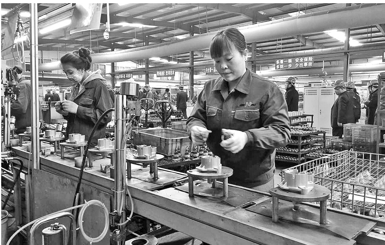
近日,在河北长立汽车配件有限公司的车间,工人在组装起动机。河北长立汽车配件有限公司是国家机电产品再制造试点单位,该公司开发设计了适用于再制造企业的质量管理体系,实现了再制造产品生产全流程标准化。 记者 王雅楠摄
