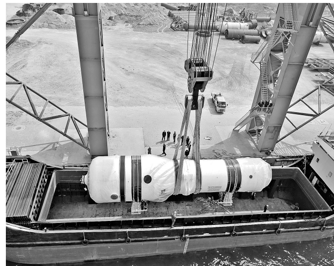
近日,哈电集团(秦皇岛)重型装备有限公司承制的3台ZH-65型蒸汽发生器顺利交货,这标志着“华龙一号”海外第2台核电机组“巴基斯坦卡拉奇3”项目即将步入主设备安装阶段。ZH-65型蒸汽发生器是“华龙一号”机组核心设备之一,总重365吨,设计寿命60年。 王继军摄
