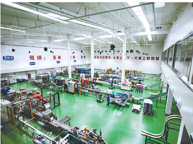
近日,君乐宝加工完成的奶粉通过全自动灌装机完成灌装,正一罐一罐被运输到奶粉包装车间进行装箱工作。近年来,君乐宝推动全产业链的转型升级,先后投资数十亿元,建设高档酸奶加工项目、世界顶级奶粉工厂项目等。其中永盛工厂项目是目前国内规模最大、设备自动化程度最高的高档酸牛奶生产车间。君源奶粉工厂全面采用国际领先工艺,整合10余个国家、20多项专利,30多家供应商的设备和技。
