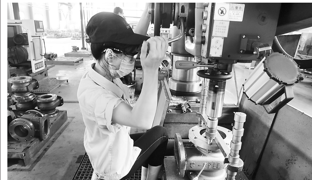
日前,远大阀门集团的一个生产单元内,一名工人正在操作钻床为阀门打孔。这是为国外一个大型化工项目生产的阀门,共有上千件。记者 王永晨摄
