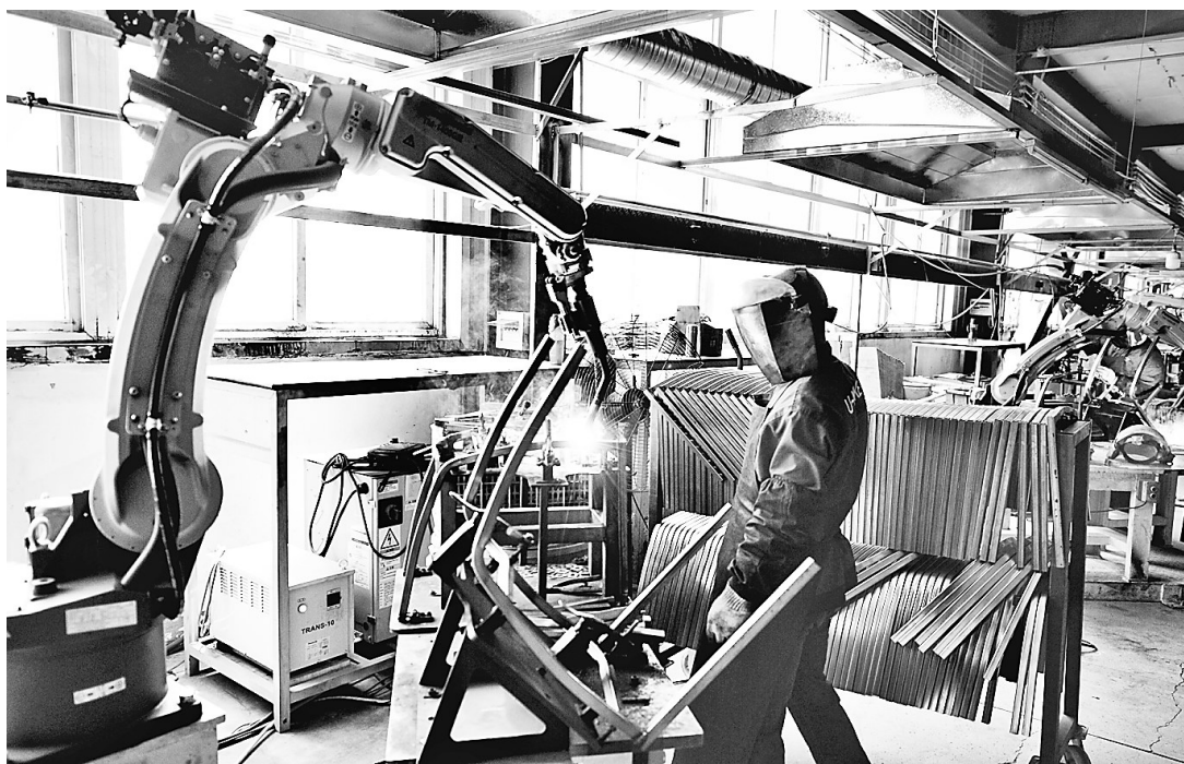
近日,霸州市纽莱客家具有限公司工人用机器人焊接椅架。近年来,霸州市以技术改造为核心,引导企业开展“机器换人”工程,着力推进制造业智能升级。目前,广泛应用于焊接、喷涂、搬运等环节的机器人正成为企业生产的主力军。 记者 杜柏桦 通讯员 徐巍摄
