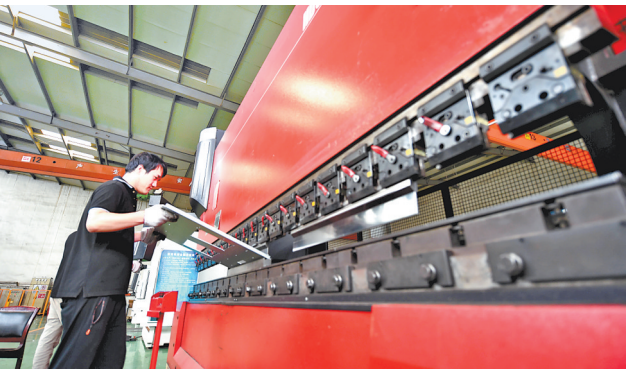
近日,文安县通达塑机机械有限公司工人利用国际领先的钣金数控折弯机加工机械设备零件。文安县紧抓京津冀协同发展机遇,打造京津冀地区具有竞争优势的高端装备制造产业基地。 记者 赵永辉摄
