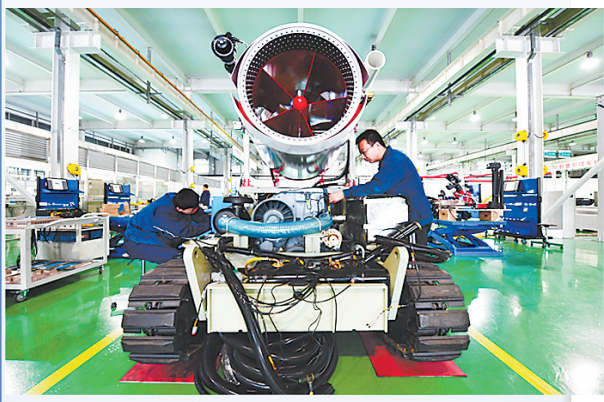
中信重工开诚公司正在调试消防机器人。
