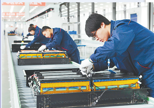
航天国轩(唐山)锂电池有限公司产线是国内自动化、智能化程度最高的产线之一。图为电池模组入箱后,工作人员在进行线路连接。
