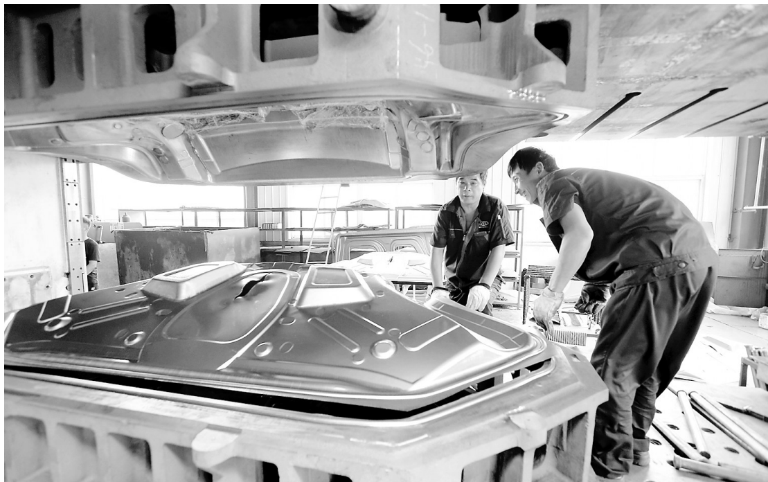
日前,在文安智能电网产业园内,北京摩托菲尔汽车技术有限公司的技术人员在检测汽车零部件的平面、曲面。该公司的主要任务是试制全球汽车生产企业的样车、概念车及改良试生产汽车的技术参数和性能。 通讯员 陈童摄
