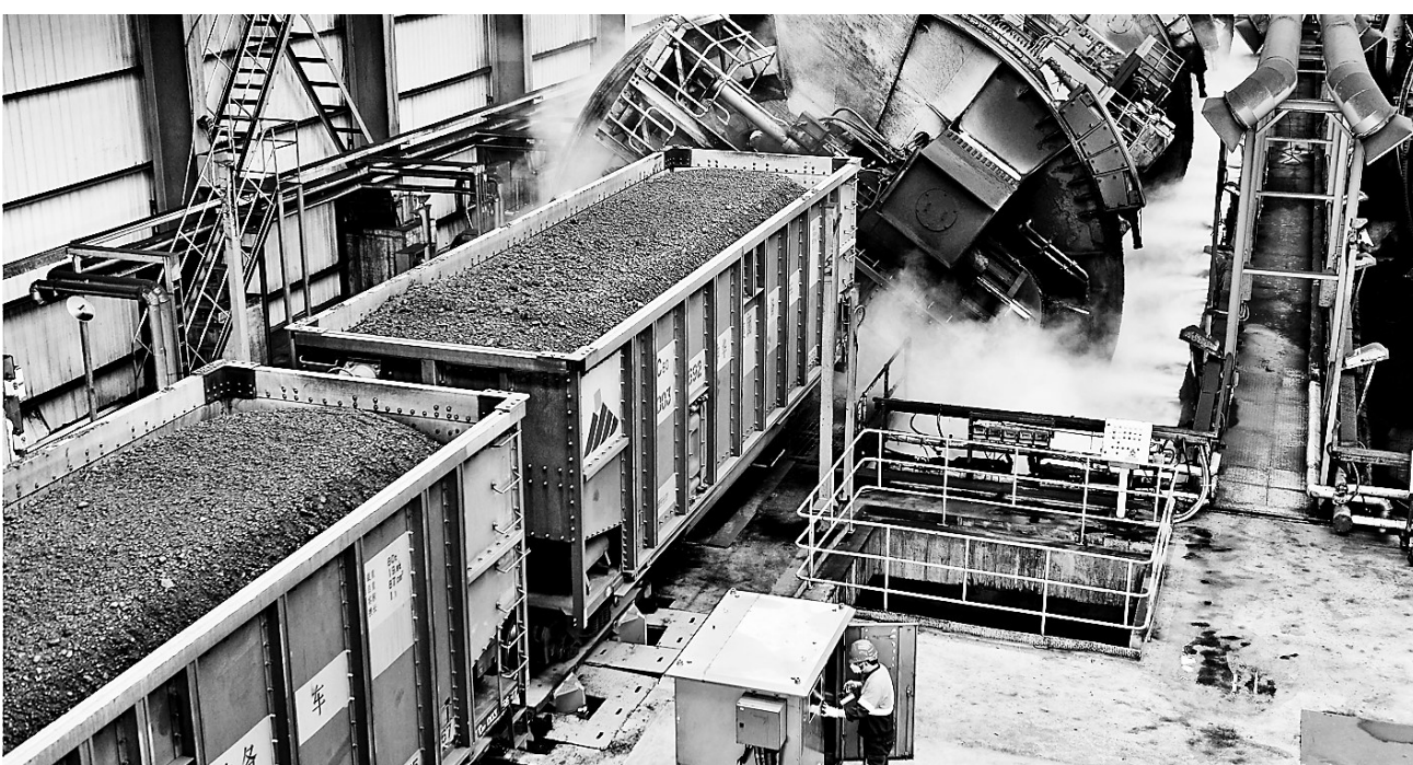
近日，在神华黄骅港翻车机房，在翻车机工作的同时，干雾除尘设备也同步进行抑尘作业。近年来，神华黄骅港积极打造绿色港口，不断加大软硬件投入，通过堆场防风网、干雾除尘等环保项目建设，实现了煤粉尘和含煤污水的有效治理。记者 张昊摄
