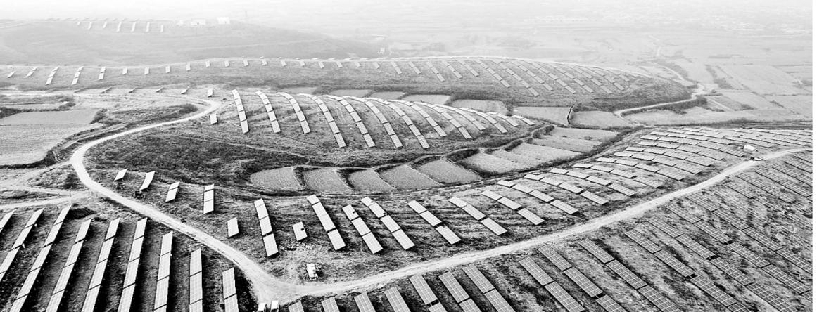
日前,中电电气集团沙河光伏发电有限公司20兆瓦光伏发电项目一期工程完工。该项目建在沙河市太行山区800多亩荒山坡上,采用分块发电、集中并网的技术方案,全部建成后年发电量2113.6万千瓦时,可节约标准煤7080吨。
