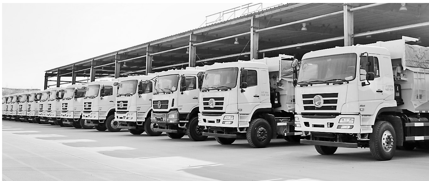
▲新下线的长征新能源(LNG)渣土车。
