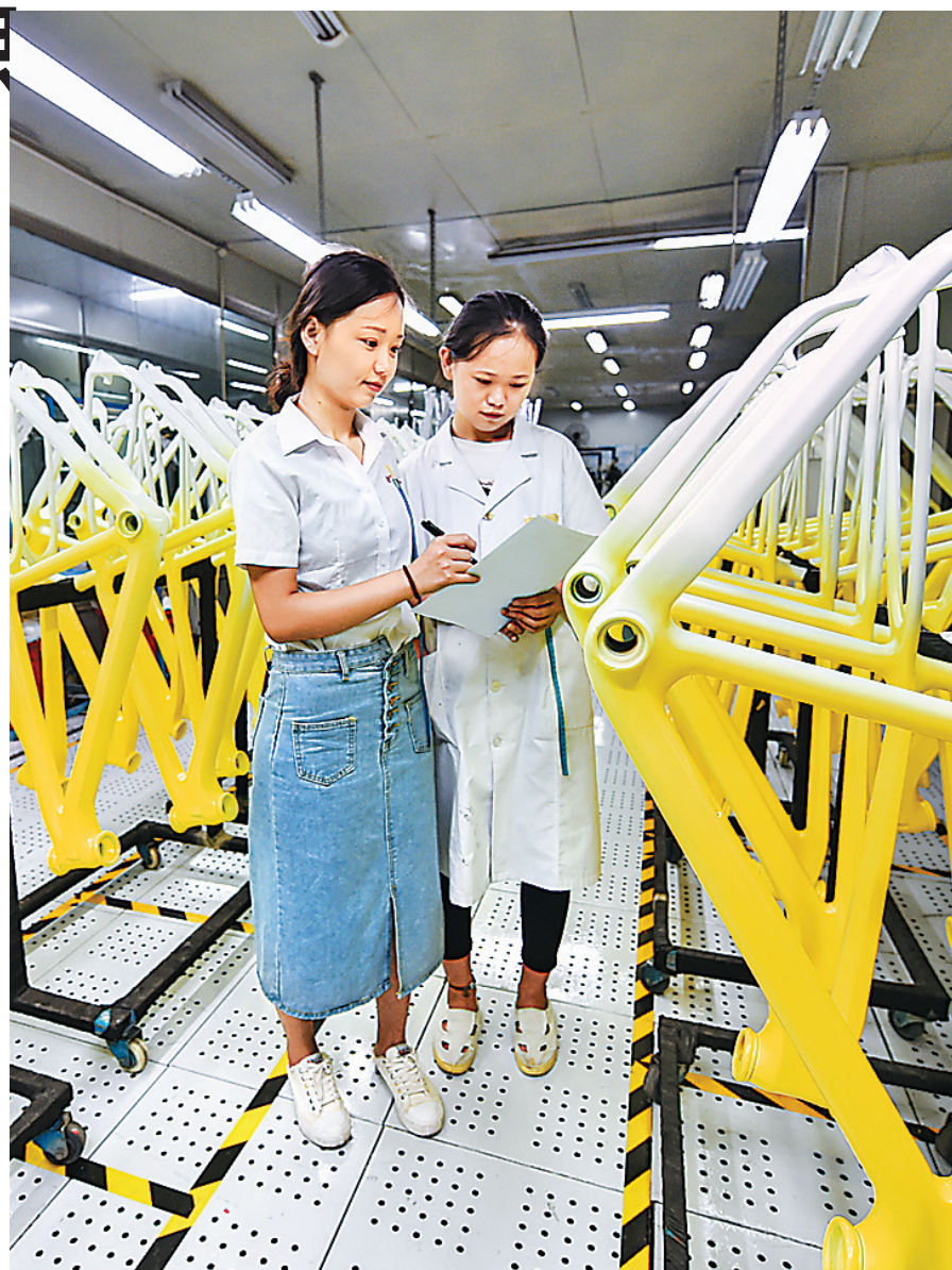
▲在唐山金亨通碳纤维科技有限公司水标无尘恒温车间,员工在对碳纤维车架抛壳打蜡后进行登记。
