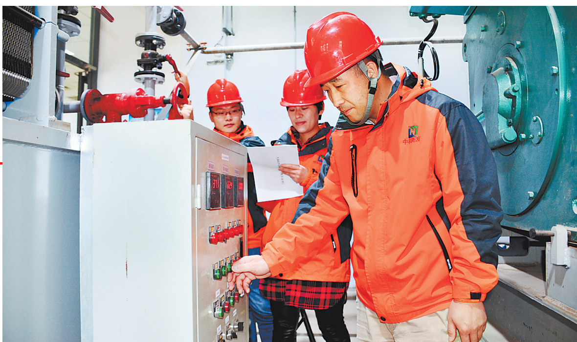
衡水科技谷内,中科衡水创新动力研发基地实验室,科研人员正在进行超临界二氧化碳装备试验机组稳定性测试。记者 焦磊摄
