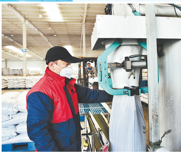
▼近日,在河北增利橡胶科技有限公司,工人正在操作打包机对胶粉进行打包。 本组照片由通讯员白永民摄
