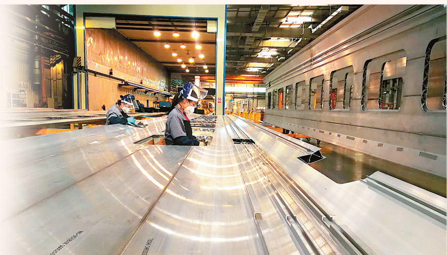
4月16日,在中车唐山公司高速动车组铝合金车体生产线,工人正在精细打磨复兴号高速动车组车体窗口边框。
