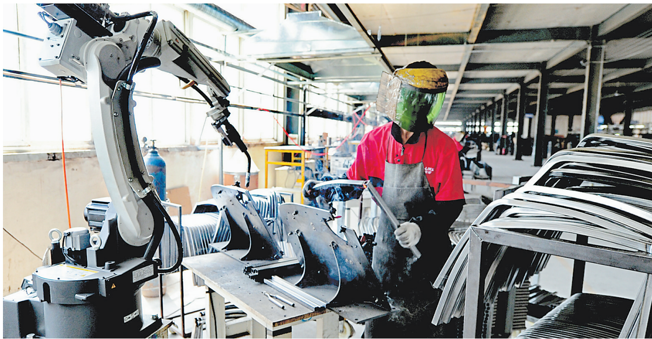
霸州市纽莱客家具有限公司工人操作机器人手焊接椅架。 记者 杜柏桦 通讯员 徐巍摄
