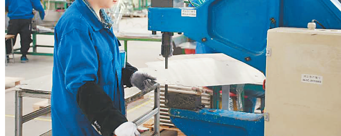
在青县经济开发区河北维冠机电设备有限公司钣金加工车间,工人正在进行压铆操作。该公司是由北京维冠集团投资7.6亿元建成的集研发、生产、销售于一体的钣金设备制造企业,今年一季度实现上缴税金495万元。青县积极抢抓京津冀协同发展机遇,促进更多科技含量高、带动能力强、财政贡献大的优质项目落户青县,带动当地产业结构调整。记者 王雅楠 通讯员 张寿松摄
