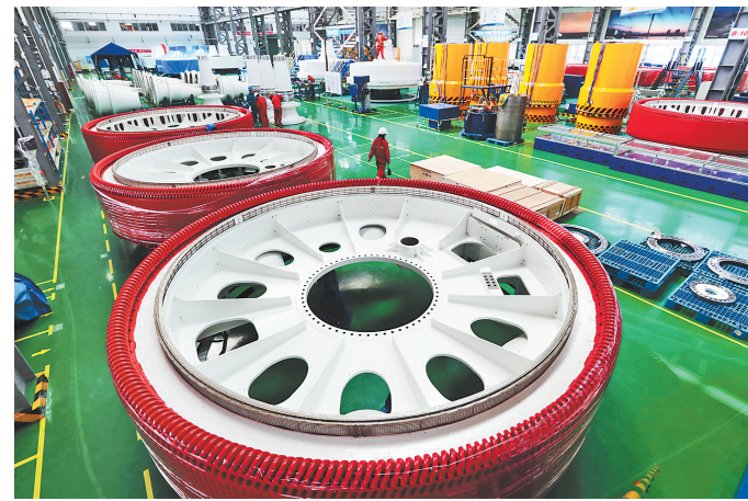
金风总装厂项目新上设备,完成技改,提升生产能级,合成孔径雷达、张家口互联网软件园整体完工运营。今年以来,张家口经开区抢抓京津冀协同发展机遇,强力推进项目建设,提升经济发展质量。图为经开区金风总装智能工厂车间生产的2.0兆瓦的定子。
