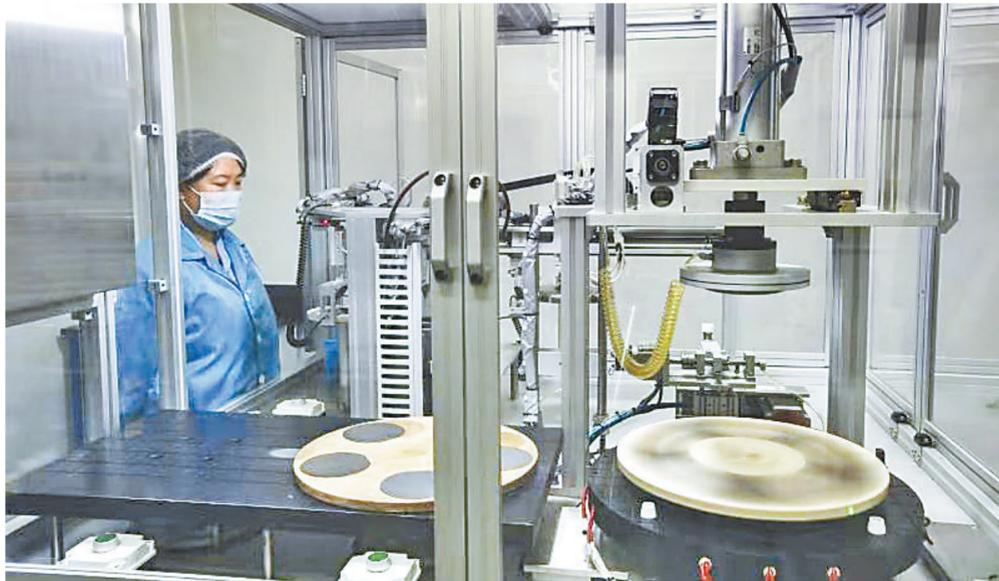
近日,河北同光晶体的技术人员在进行碳化硅单晶衬底贴片操作。
