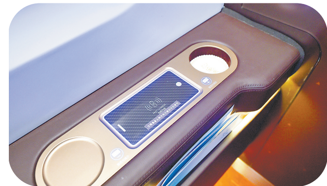
12月30日,G8811次智能动车组上的无线手机充电设备。 记者 赵杰摄
