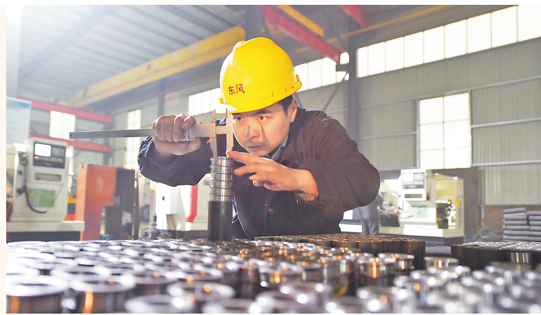
1月14日,位于广宗县的河北东风世景模板有限公司工人在检测铁路防腐预埋件产品精度。 河北日报记者 赵永辉摄
