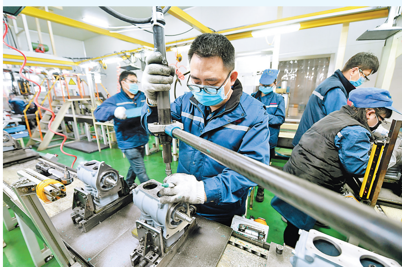
2月25日,工人在位于安次区的瑞立美联动技术(廊坊)有限公司组装车间内安装连杆螺钉。 河北日报通讯员 刘建斌摄
