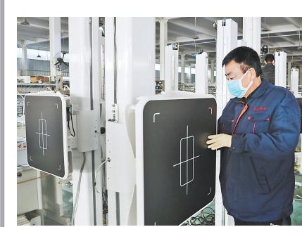
香河县宏远机械制造有限公司车间内,工人正在组装医用透视设备零部件。
