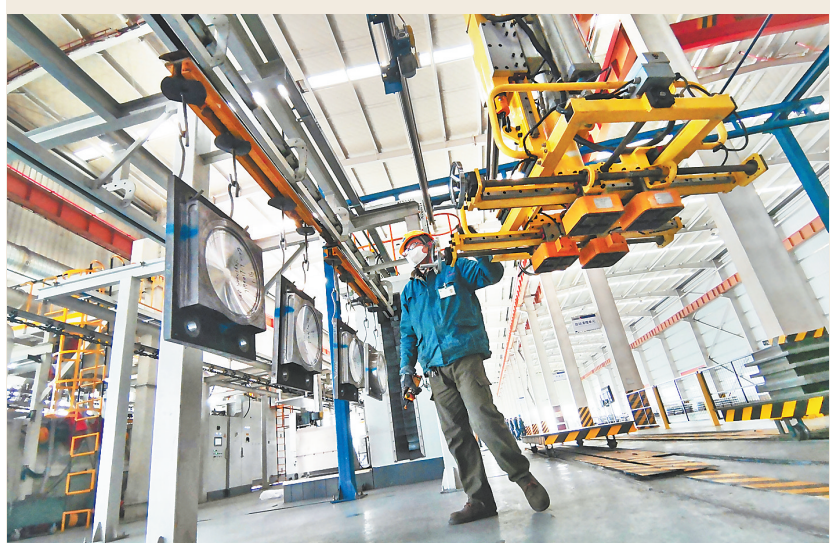
近日,在位于衡水高新区的河北丰泽橡胶股份有限公司的金属支座柔性自动组装机上,工人在操作设备进行生产。该公司与中国航空工业集团共同开发设计的金属支座柔性自动组装机,自动化程度和技术性能达到国际先进水平,生产效率提高了50%以上。
