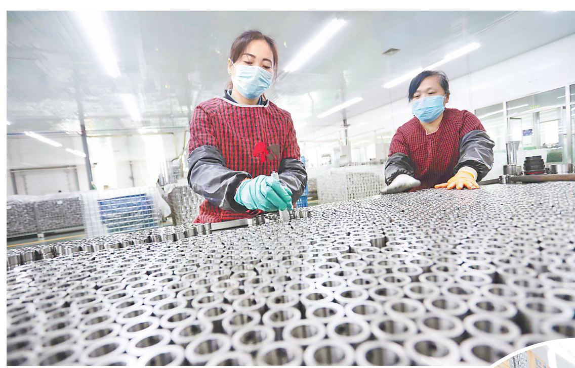
日前,河北海蓝轴承制造有限公司员工在对轴承产品内圈进行分类整理。
