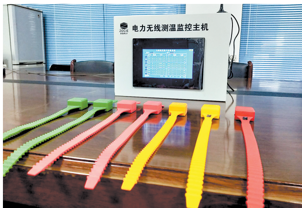
图为河北卓智电子技术有限公司应用通用模块化物联网服务器技术设计的电力无线测温监控系统,其中的带状设备为无线传感器。
