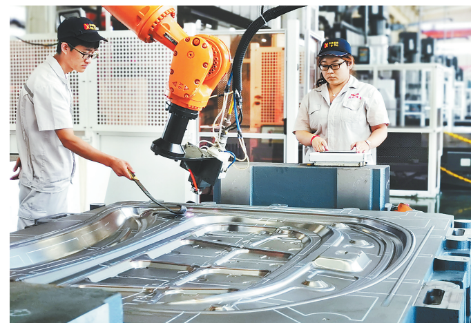
日前,在泊头市兴达汽车模具制造有限公司车间内,工人正在利用激光淬火技术,对模具进行热处理。近年来,泊头市立足铸造、环保设备、汽车模具等特色产业基地,深入开展铸造产业整改提升、工业产业综合提升工程,全力推进特色产业转型升级,促进全市经济高质量发展。
