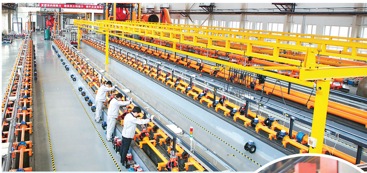
▲近日,汇中仪表股份有限公司员工在大口径实流检定中心检定管段式超声热量表。疫情期间,唐山高新区为该公司减免社保费和电费,护航企业健康发展。河北日报通讯员 宋旭东摄
