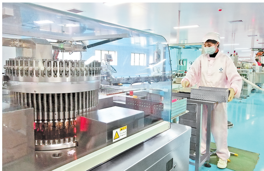
在神威药业现代中药数字化车间,工作人员正在通过全自动灯检机进行清开灵注射液灯检操作。 河北日报记者 马彦铭摄
