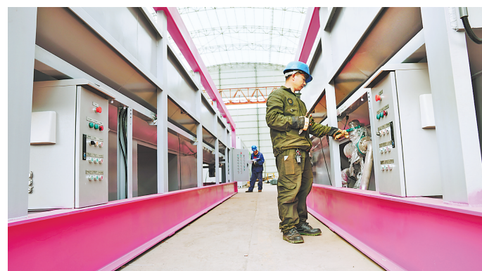
日前,日产360吨污染土壤异位热脱附及污染物回收系统在秦皇岛开发区春光铸造机械有限公司研制成功,并开始应用于有机污染土壤修复和污染物回收,回收率可达90%以上。这是该公司技术人员在调试设备。
