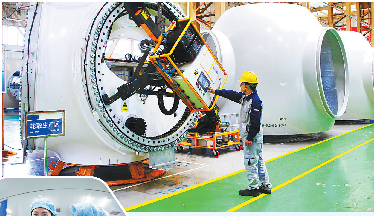
▲近年来, 作为国内风电装备制造领军企业, 国电联合动力技术(保定)有限公司集中优势力量, 研发出适合主流市场需求的王牌机型, 成为全球领先的风电整体解决方案提供商。这是工作人员正在操作变桨螺栓机器人打力矩。河北日报通讯员 李涛涛摄
