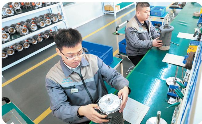
▲3月12日,河北金士顿科技有限责任公司装配车间内,技术人员正在对公司自主研发的氢燃料电池用空压机进行调试。
