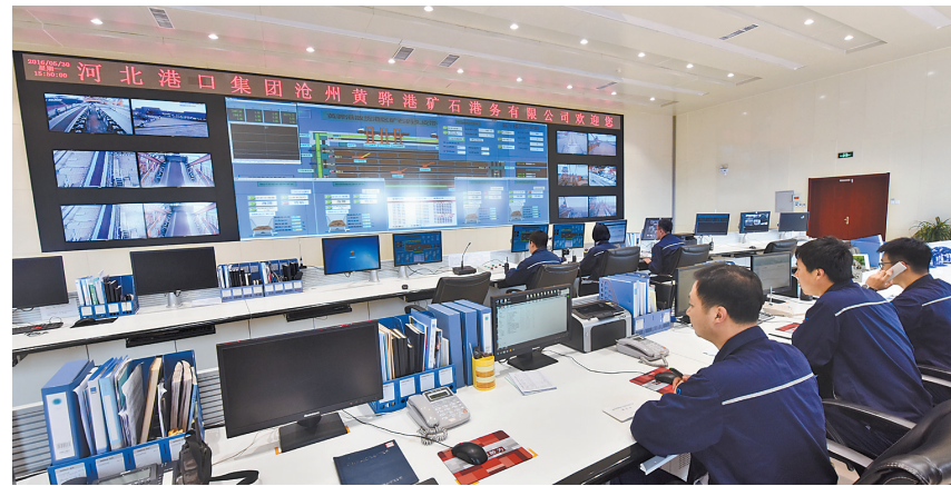
在黄骅港矿石港务有限公司,大型起重机远程控制监视系统等数字技术的应用,提升了码头作业效率。 河北港口集团供图
