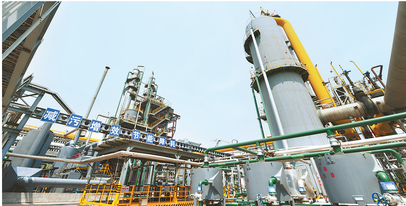
近年来,河北旭阳能源有限公司改变原有脱氨工艺,使能耗明显降低,并使现场操作环境得到了改善。这是该公司化产五车间磷酸洗氨工艺运行现场。
