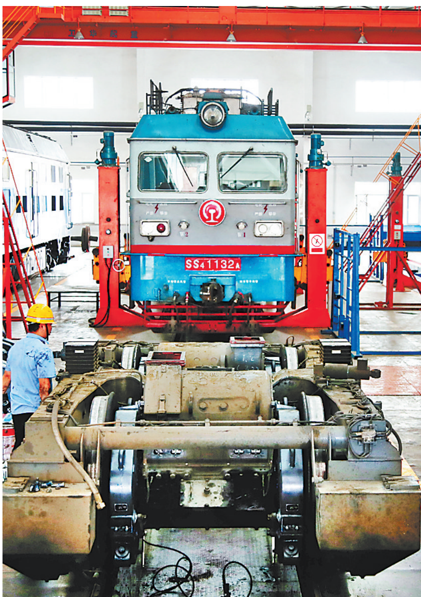
▲在朔黄铁路运输处黄骅港折返段检修大库内,检修工在检查处理机车齿轮箱漏油问题。
