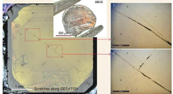
用AM-III刻划金刚石(001)面留下的划痕(资料照片)。8月14日,记者从国家重点实验室之一的燕山大亚材料制备技术与科学实验室获悉,新型非晶材料(AM-III)近日在该实验室成功合成。AM-III密度与金刚石相当,维氏硬度HV高达113GPa,可划伤单晶金刚石。新华社发
