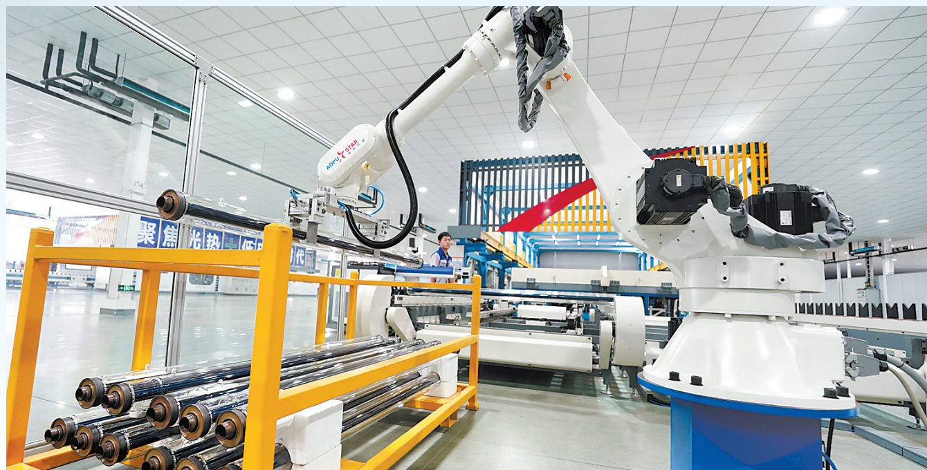
在威县高新技术产业开发区,一家清洁能源产品生产企业车间机械手在搬运太阳能集热管。 新华社记者 骆学峰摄
