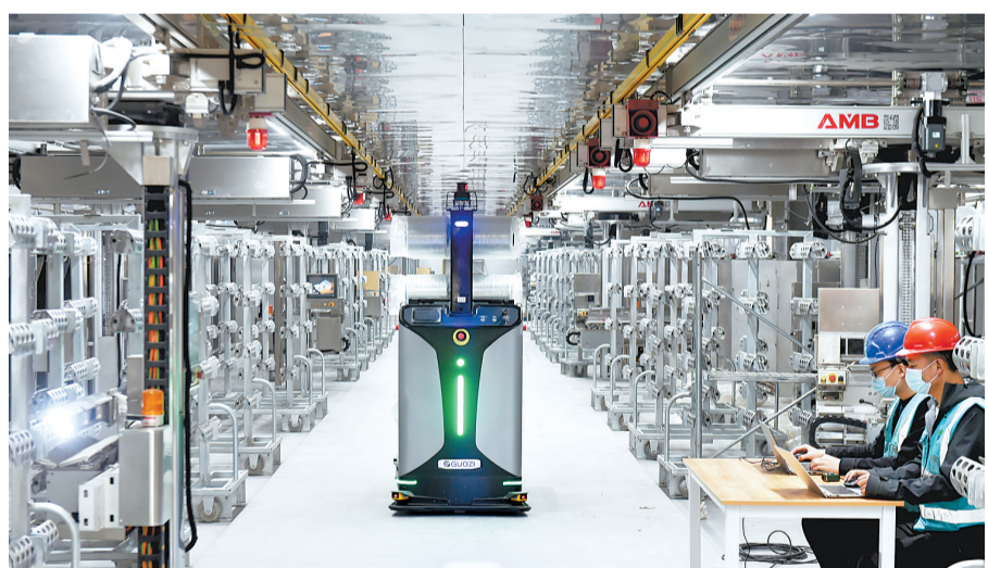
▲图为冀中股份河北冀中新材料有限公司纤维车间的技术人员在调试激光自动导航搬运机器人。该公司利用人工智能技术,进行传统产业向数字化、科技化、智能化转型升级,提高生产效率,实现高质量发展。(本报资料图) 河北日报记者 史晟全摄
