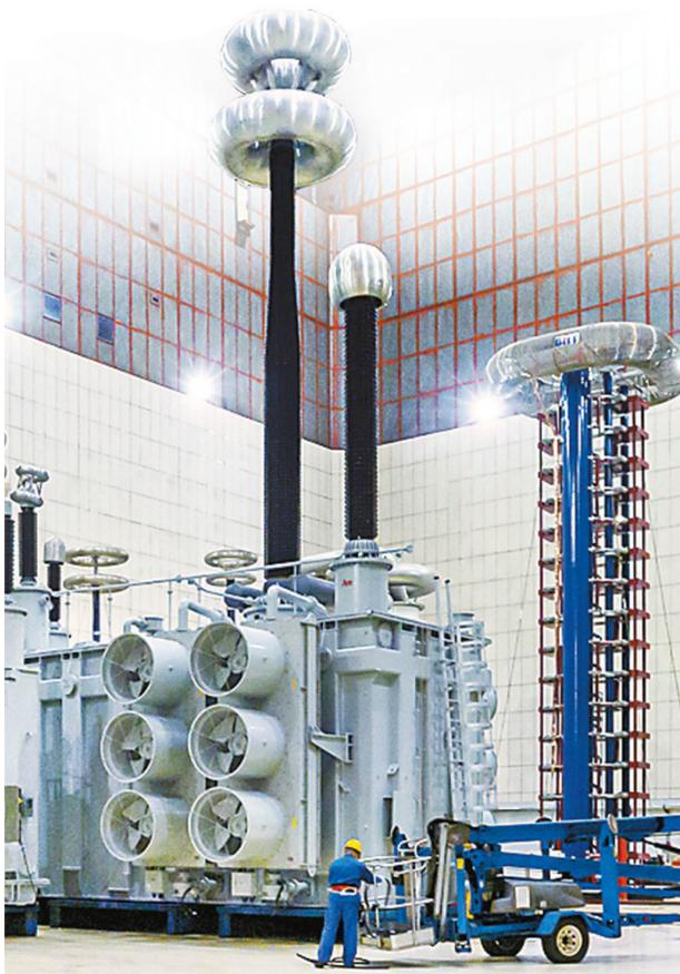
▲11月5日,在保定天威保定电气股份有限公司特高压实验室,一台(套)特高压变压器正在进行出厂前测试工作。该公司研制的特高压输电用变压器设备技术水平处于国际领先水平。
